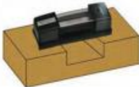
تراز بودن سطح
